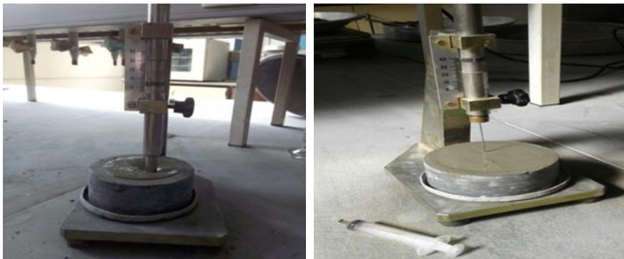
الشكل (9) يوضح عينة المونة المخلوطة مع الزيت و العينة الأخرى الغير مخلوطة بالزيت عند قياس زمنى الشك الابتدائي و النهائي.
