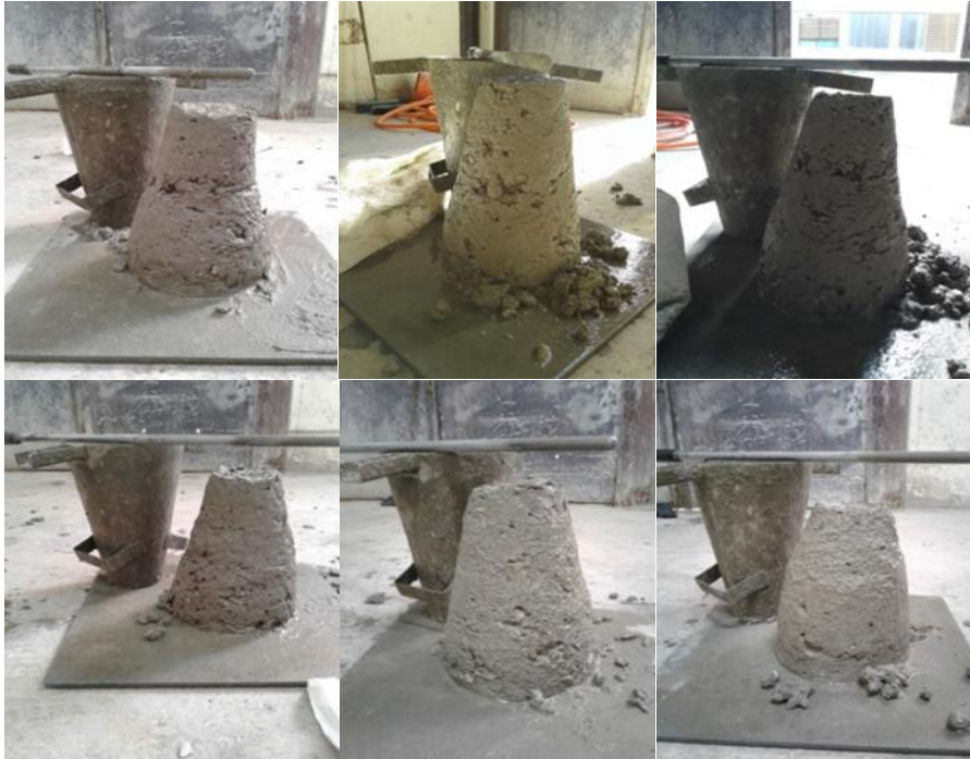
شكل (8) يوضح الهابط بالخلطات الخرسانة عند اضافة زيت المحركات المستعمل.
