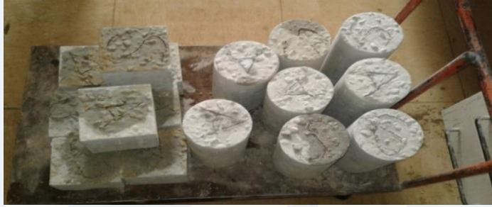
شكل (9) العينات بعد اخراجها من خزانات المعالجة بعد 28 يوم.
