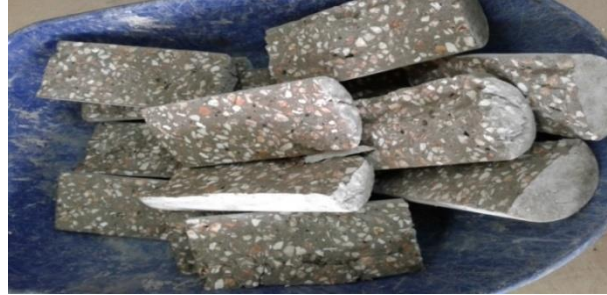
شكل (11) اشكال الكسر و الانهيار بالعينات بعد الانتهاء من اجراء اختبار الشد للخرسانة المحتوية علي الزيت.
