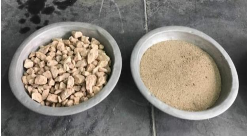
شكل (2) يوضح الركام الكبير والصغير المستعمل بالمشروع .
