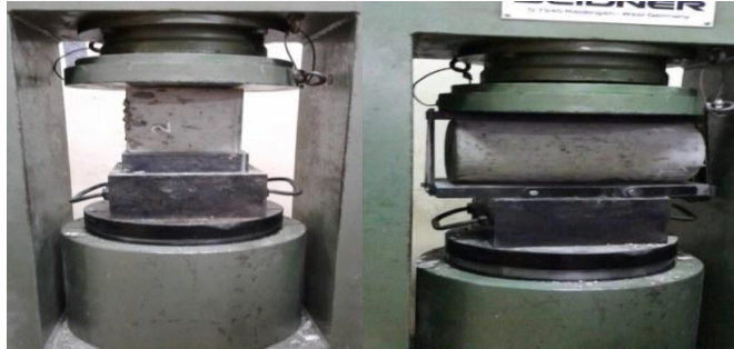
شكل (10) وضع العينات لقياس مقاومة الخرسانة للضغط و مقاومتها للشد.
