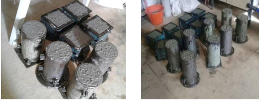
شكل (7) يوضح العينات في شكلها النهائي بعد الخلط و الصب دون اضافة الزيت ومع اضافة الزيت.
