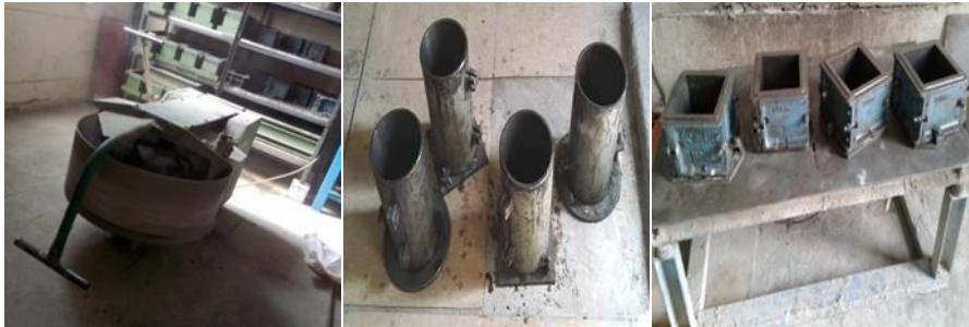
شكل (6) يوضح القوالب للعينات بعد تشحيمها و تجهيزها للصب مع الهزاز الميكانيكي و الخلاط المستخدم.
